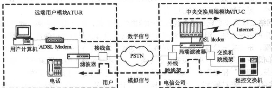
图 1-3 典型的 ADSL 的接入模型图
