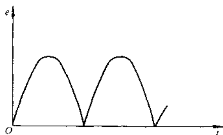
图 1-2 一个线圈时电刷两端电动势的波形
