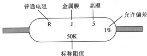
图 1-1 电阻器规格直标法
