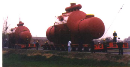
仪征化纤冷凝器运输 13×5.6×7.6m重112吨
