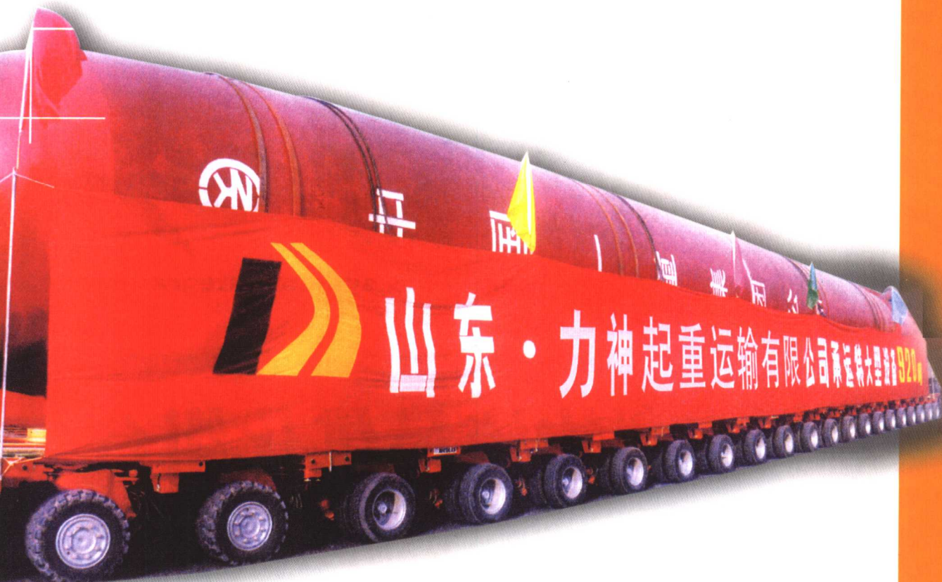
仪征化纤冷凝器运输 24.4×5m重180吨
