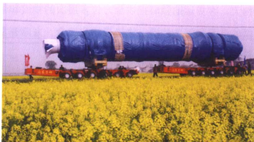
仪征化纤冷凝器运输 24.4×5m重180吨
