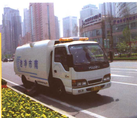
全吸干式机扫车,实现了 机械化清扫零的突破
