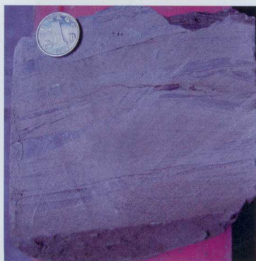
照片 31 陈 2-20 井 2120.0m 泥质粉砂岩,水平缝
