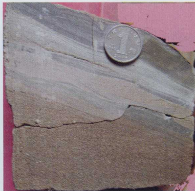
照片 7 陈 2-14 井 2151.5m 粉砂岩, 水平缝、诱导缝
