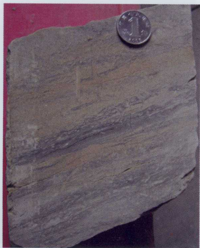
照片4 陈2-14井 2136.4m 泥质粉砂岩,水平裂缝、垂直裂缝
