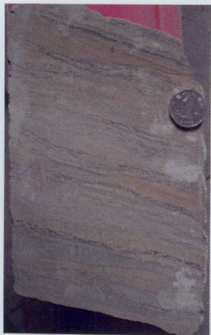
照片1 陈2-14井 2134.0m 泥质粉砂岩,水平裂缝
