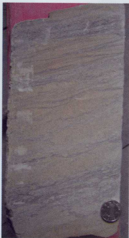
照片2 陈2-14井 2135.0m 泥质粉砂岩,水平裂缝
