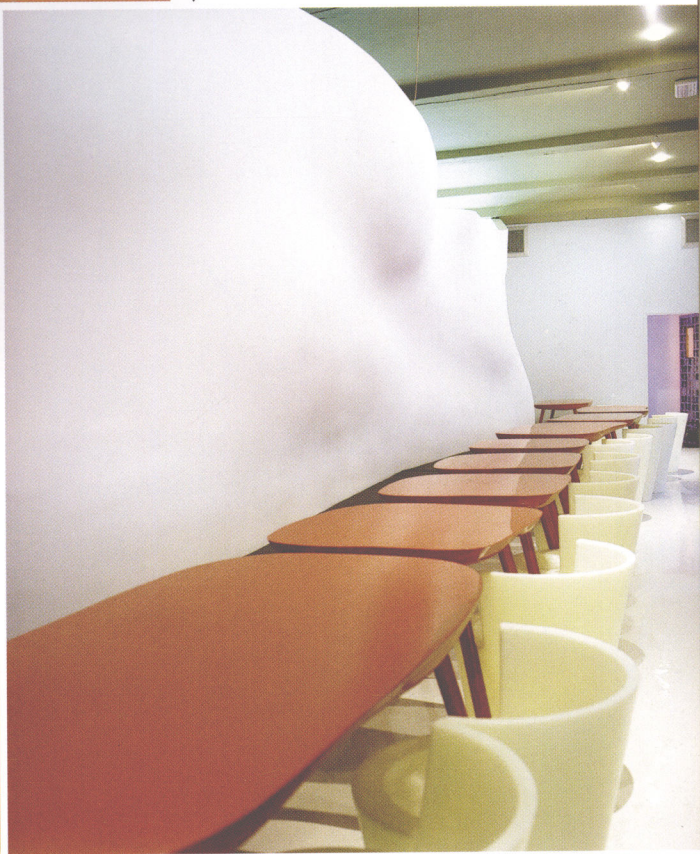
酒吧餐厅内，一面巨大的波浪状墙体横贯东西，将厨房与餐厅分隔开来，形成一个较为安静的空间。墙体内部为金属构造，表面则以混凝土覆盖
