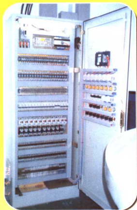
▲ 封闭式龙门型/电镀生产线 [PLC程式控制]
