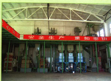
种子加工车间的自动化种子包装设备
