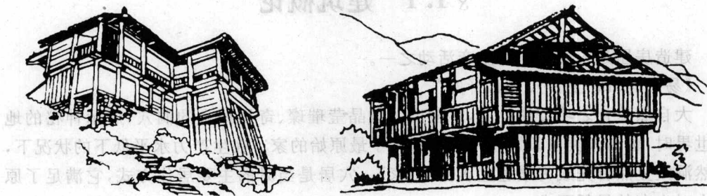
图 1.1 干阑式木结构建筑
