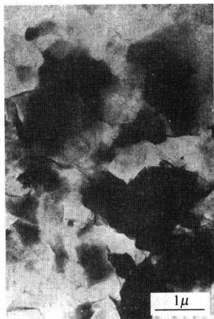
图 1.6 钠蒙脱石的电镜照片
