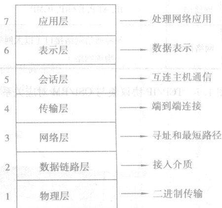
图 1.6 ISO 制定的 OSI/RM(开放系统互联/参考模型)
