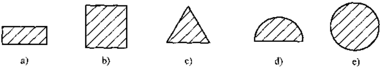
图 1—3 普通钳工锉的断面形状
