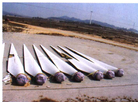
彩图 28 损坏叶片地面照片(二)
