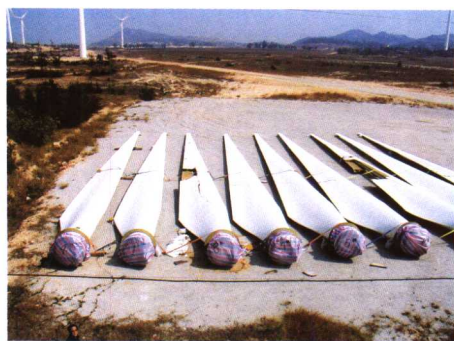
彩图 27 损坏叶片地面照片(一)
