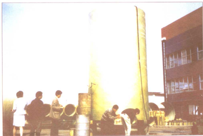
口径为3100mm、长度为12m的玻璃钢夹砂管，已置于试验台上进行内水压力检验
