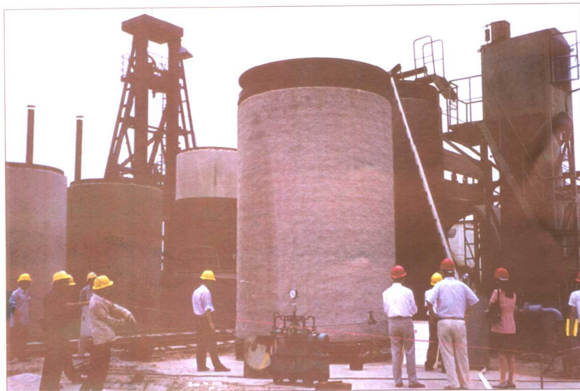
PCCP管出厂前进行内水压力试验
