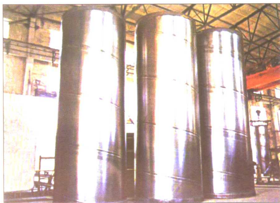
PCCP管钢筒制造
