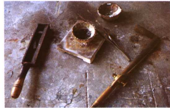
图 1-3 各种工具:焊枪、焊活渣垫、钳子、镊子、坩埚等等。
