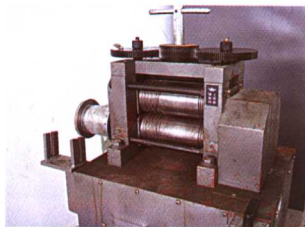
图 1-9 轧片机 用于压轧不同规格不同需要的金属片或条,是用于首饰造型的工作台的辅助电动设备。
