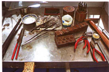
图 1-2 各种工具:铁墩、窝作、焊台、坑铁、台塞、卡尺锉等等。
