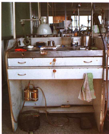
图 1-1 这是从首饰公司车间拍摄到的一台使用状态下的工作台,借助它基本上可以完成一般首饰的造型。锯、锉、烧焊、钻孔、研磨等等工艺所需的工具一应俱全。对于经验丰富的技师,工作台会有更加丰富和出其不意的功能。
