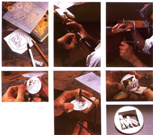
图 1-37 仅用锯、锉、焊等简单工艺制作胸针的程序。这枚胸针作品及其制作过程告诉我们，有了锯、锉、焊的工艺，就可以在首饰设计的过程中捕捉自己感兴趣的事物了。
