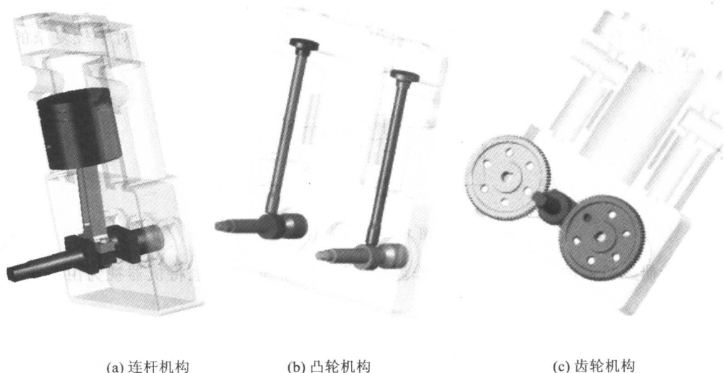
图 1.9 单缸四冲程内燃机中的机构
