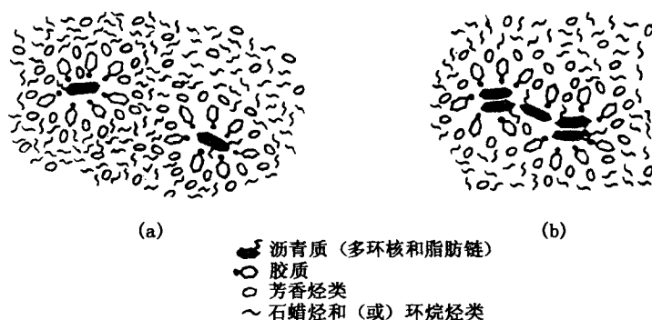
图 1-1-3 胶质和沥青质在原油中的胶束结构
