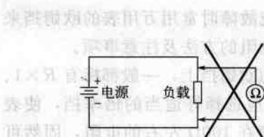
图 1-6 测量电阻的错误方法
