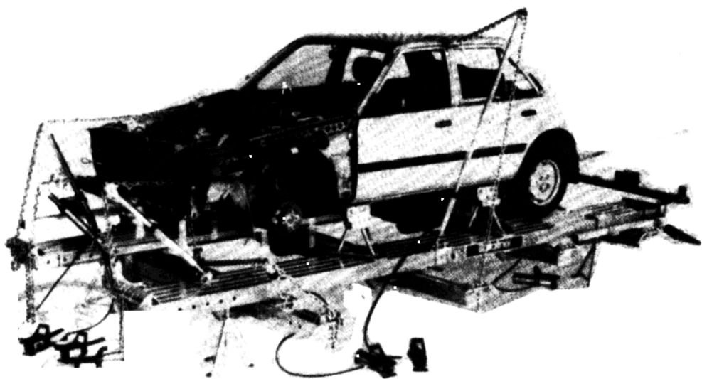
图 1-1 工作中的液压拉伸设备
