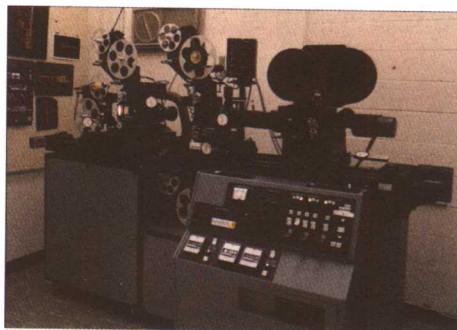
图3 这是一台折磨人的设备？对于操作者来说确实如此。在数码时代之前，像这样的光学印刷机是电影合成的惟一方法，这是一项充满艰辛、追求完美的工作
