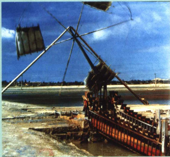
图7 翻车（龙骨车、踏车），东汉灵帝（公元168—189年）时毕岚作翻车，后经三国马钧改进用于农田灌溉，提水功效高，很受人们欢迎，推广至各地。至唐代已成为农村最重要的灌溉机械。其动力有手摇、手转、脚踏，牛转，风力等。图为至今仍发挥效益的风力龙骨车
