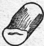
圖10 夾雜有非金屬雜質的鋼材，在鍛造時產生的裂紋。
