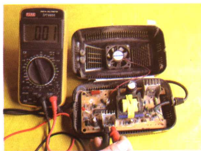
48V20A·h 充电器内部测量图
