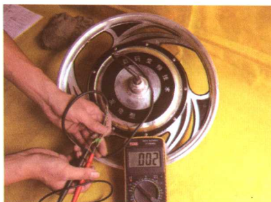
48V350W 无刷变频电机测量图
