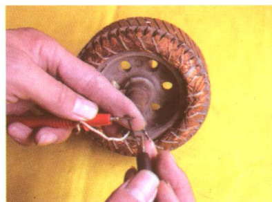
有刷电机定子测量图
