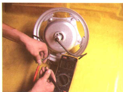
48V500W 无刷电机测量图
