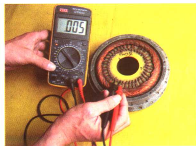
有刷电机线圈测量图
