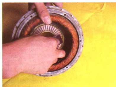
有刷电机换向器维修图
