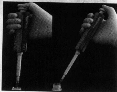
图 2-6 移液枪吸液时的操作 (图左为正确操作，图右为错误操作)
