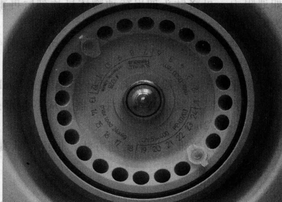
图 2-7 离心样品平衡对称放置在离心转子上
