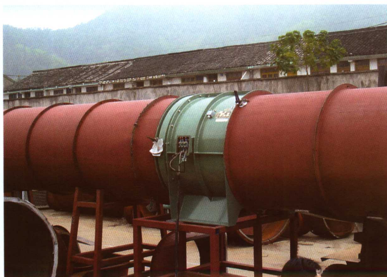
UPE-OTE 风机出厂验收噪声测试
