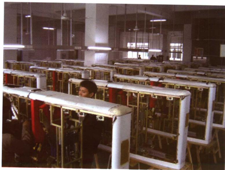
自动售票闸机正在组装中
