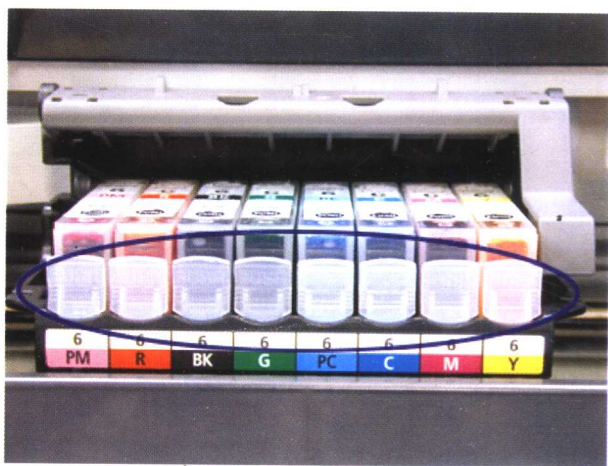
图 7-14 正确的安装情况
