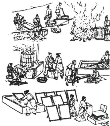
图1-4 中国汉代造纸工艺示意图
