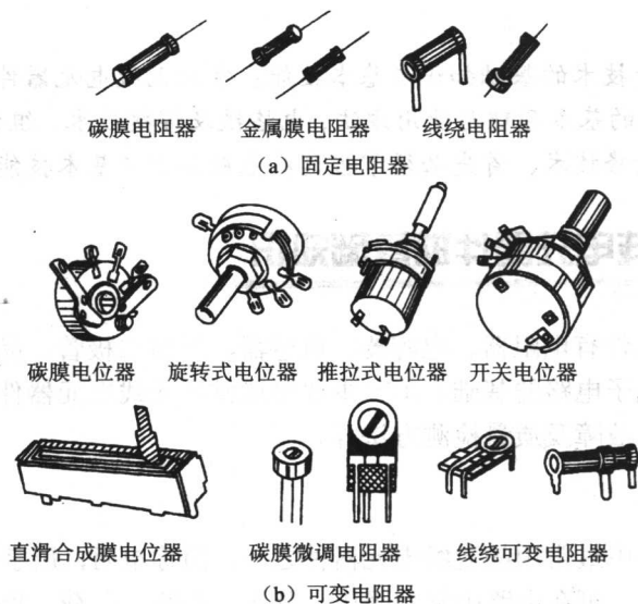
图 1-1 常用电阻器的种类及结构
