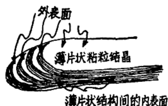
图 1—1 层状粘粒矿物的内表面示意图
