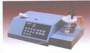
RPA系列 溴价/溴指数测定仪 测量范围： 溴价: 0.1 \sim 300 \text{g Br}/100 \text{g} 溴指数: 0.2 \sim 1000 \text{mg Br}/100 \text{g}
