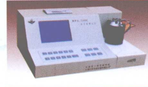
RPA-100C盐含量测定 采用微库仑滴定原理，盐含量： 0.2 \sim 10000 \text{mg/L} CL: 0.1 \times 10^{-6} \sim 1 \times 10^{-2}
