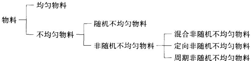
均匀物料的采样,原则上可以在物料的任意部位进行。但要注意采样过程中不应带进杂质,避免在采样过程中引起物料变化(如吸水、氧化等)。
