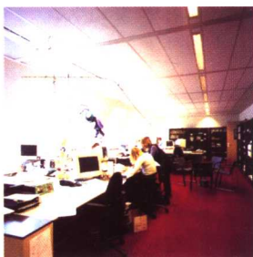
图 23-16 办公室的人工照明可被个人控制，照度在 25~800lx 之间变化。灯具采用了单管 TL5/49W 的 TBS600 嵌入式格栅灯
