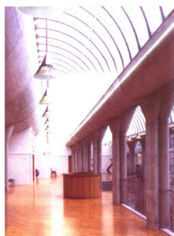
图 23-12 中庭主要采用天然采光，显示出更加自然的氛围，可利用立面上的金属格栅控制眩光
