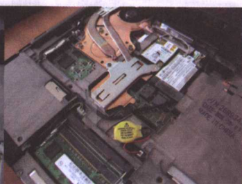
BIOS 电池直接处于键盘的下部,用透明胶条固定住
