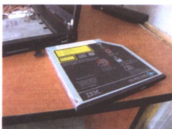
拆下 COMBO 光驱，完成外设及表面结构的拆卸
