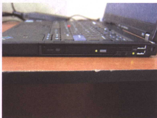
DVD 光驱、红外接口、WLAN 开关、2 个 USB 接口、笔记本电脑锁孔被设计在机器的右侧
