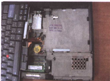
拆下键盘,看到笔记本电脑的内部结构设计
