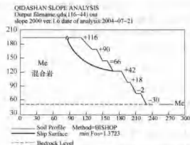
图6 采用 BISHOP 法计算边坡现状的安全系数和滑移面
