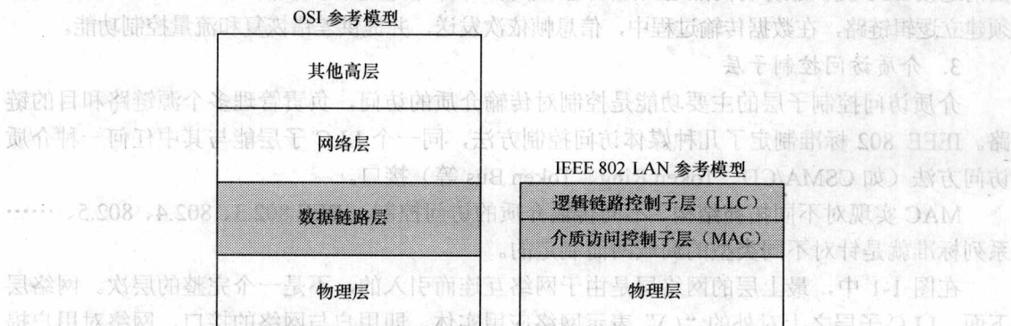
图 1-2 IEEE 802 参考模型与 OSI 参考模型的关系
