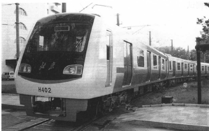
图 1.1-1 我国研制生产的 DKZ6 型无涂装不锈钢地铁车辆
