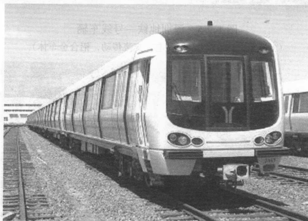
图 1.2-3 广州地铁二号线车辆 (A 型车, 1500V 接触网受电, 交流传动, 铝合金车体)
