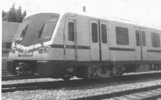
图 1.2-2 上海地铁四号线车辆 (A 型车, 1500V 接触网受电, 交流传动, 铝合金车体)
