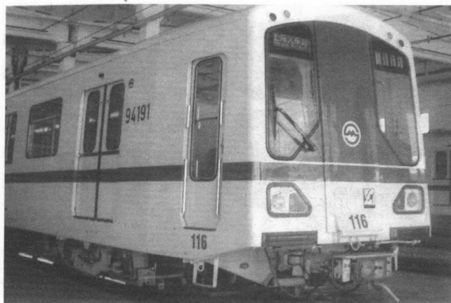
图 1.2-1 上海地铁一号线车辆 (A 型车, 1500V 接触网受电, 直流传动, 铝合金车体)
