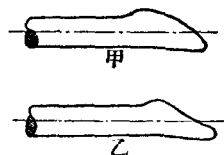
圖 6 斜口接頭的形狀： 甲—正確的；乙—錯誤的。
