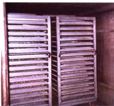
彩图11 糯玉米在蒸汽箱内漂烫
