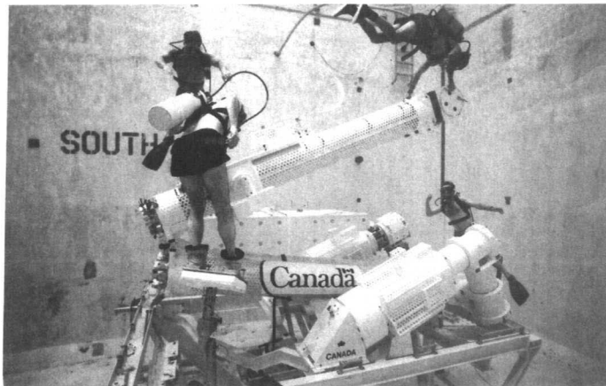
图 0.2 加拿大的移动服务系统的空间站遥控机械臂系统(SSRMS)在水下试验
