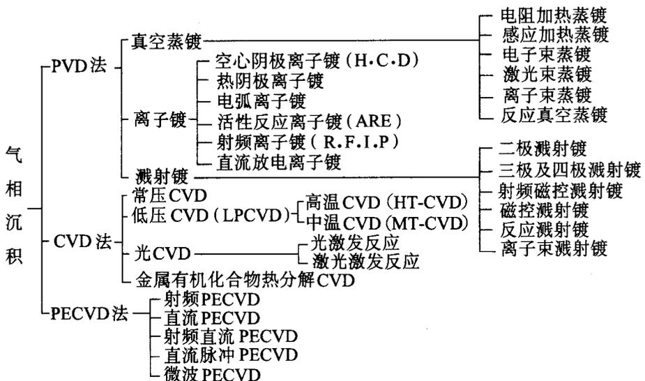
目前在实际生产中常用的工艺方法是：CVD 技术中低压 HT-CVD 和 MT-CVD；PVD 技术中的离子镀和溅射镀；PECVD 技术中直流脉冲 PECVD 和微波 PECVD。
