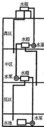
图 1-6 高位水箱串联给水系统
