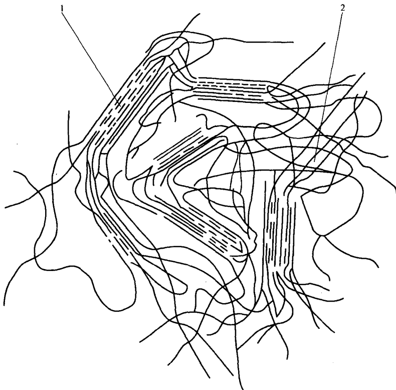
图 1-3 结晶型聚合物分子结构示意图
