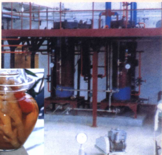
超临界 \text{CO}_2 萃 取装置——生 姜净油提取
