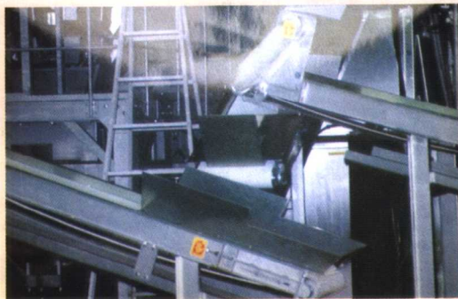
生姜制品自动生 产线(输送机械 及自动称量机)
