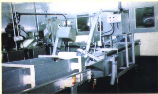
生姜制品自动 生产线(脱盐及 输送机械等)
