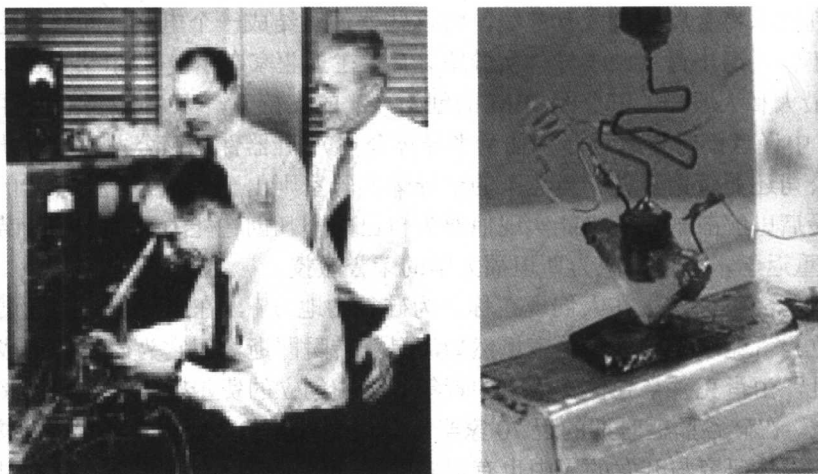
图 0-1 晶体管发明人肖克莱 (坐者)、布拉顿 (右立者) 和巴丁及其伟大发明的原始装置
