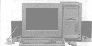
认识电脑从了解电脑的常规配制开始，电脑一般由主机、显示器、键盘和鼠标几个部分组成。电脑从功能上还可以划分为主机和外设两个部分。
