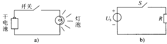
图 1-1 手电筒实际电路及电路模型
