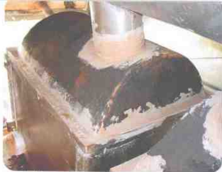
▲ 密集式烤房的蜂窝煤火炉炉体
