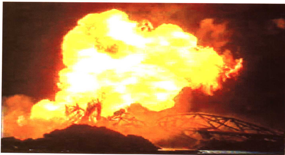
王 15 - 33 井井喷着火将井架烧倒后火场情况
