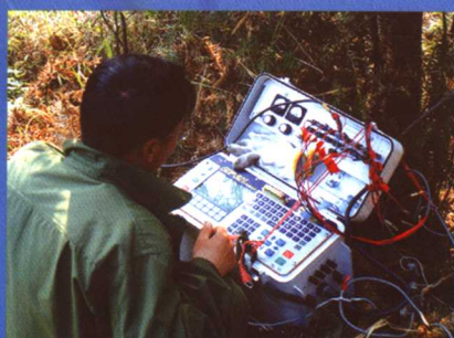
采用美国GDP32 II 多功能电法仪进行隧道选址勘查
